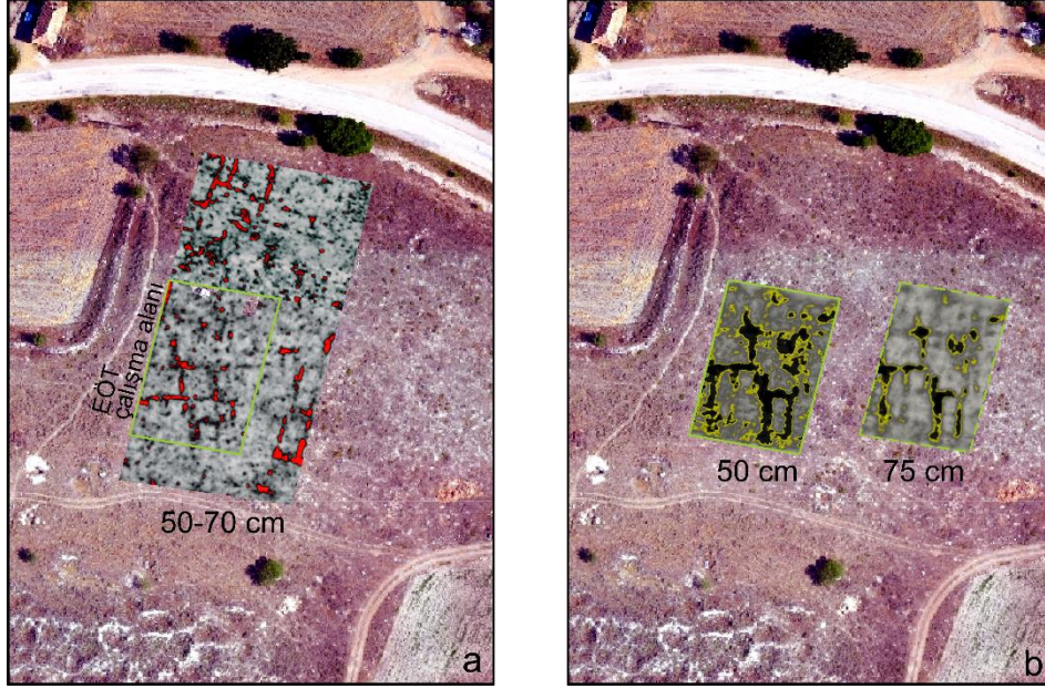
Şekil 2 a Yer radarı ve EÖT çalışmasının sonuçlarının karşılaştırılması a 50-70 cm GPR derinlik kesiti ve b 50 cm ve 75 cm EÖT derinlik seviyeleri kesiti
