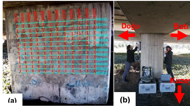
Şekil 1 a) Kırmızı çizgiler tomografi ve genel ofset ölçüm profillerini, turkuaz çizgiler yatayda genel ofset ölçüm profillerini, sarı noktalar ise verici anten noktalarını göstermektedir. b) ölçüm alım şekli.
