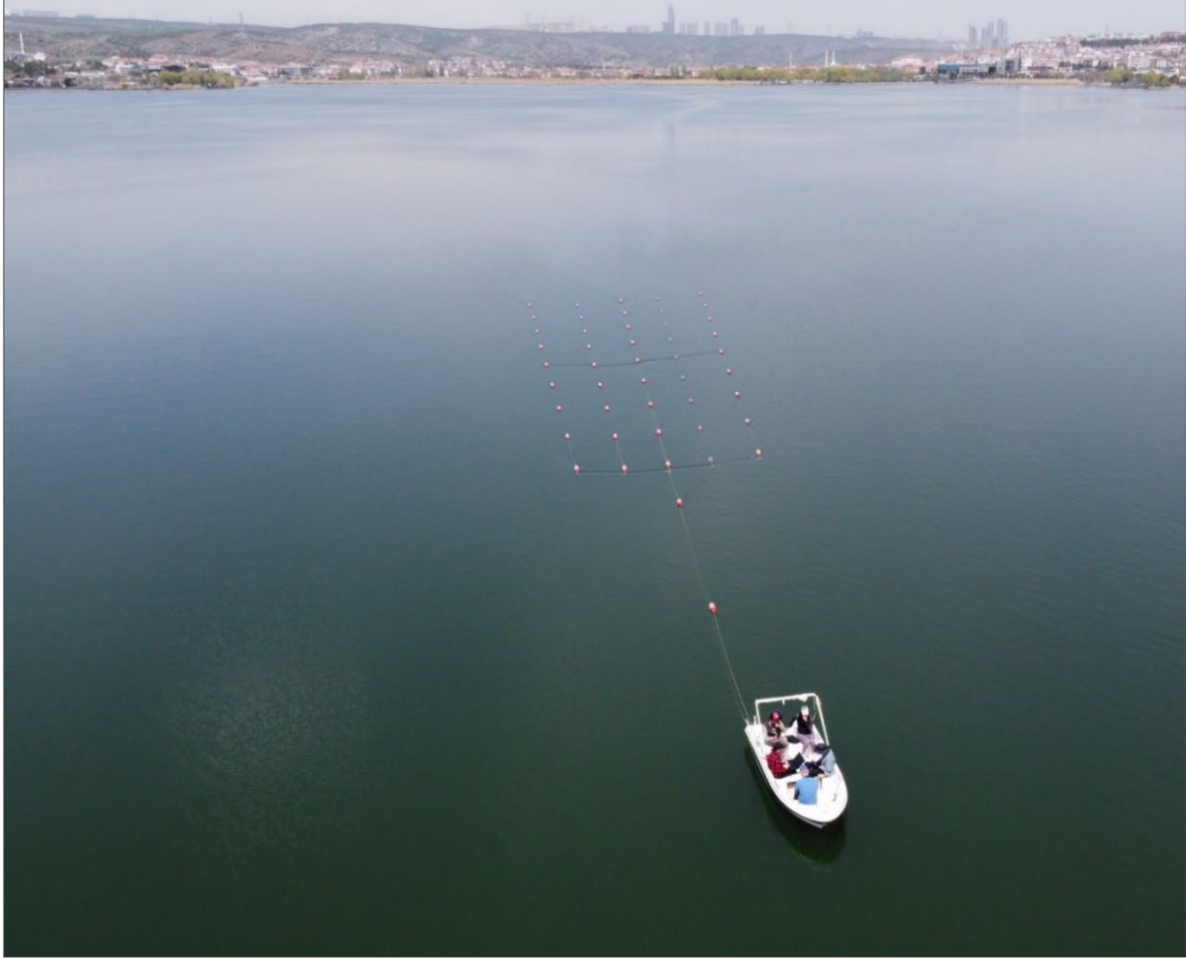
Şekil 1 MARES beş serimli ölçüm sistemi ile ölçü alınması
